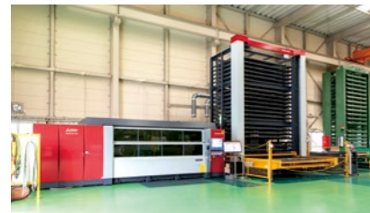
三菱電機製レーザ加工機「ML3015eX-F80」20段スタック装着。
