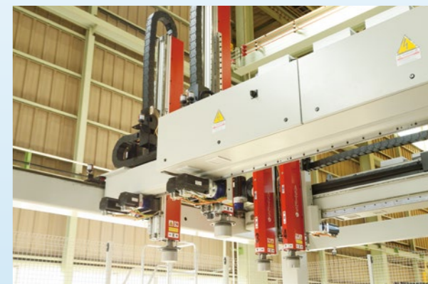
国内初の導入となる「ASTES4 SORT」は、4つのアームで材料の仕分けから加工完了品のピックアップ、端材の撤出まで難なくこなす。多田社長がひと目惚れした一品。
