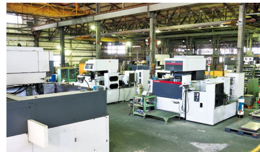
工場建屋内では、同社の厳しい要望に応える三菱電機製ワイヤ放電加工機が現在4台稼働している。
