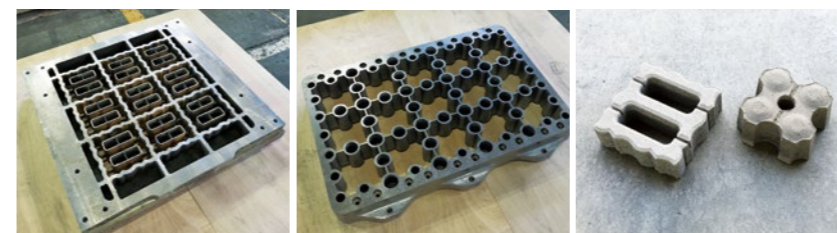
左と中央の写真がコンクリートブロック製造に使われる金型、右の写真がそれぞれの金型から製造したブロック。
