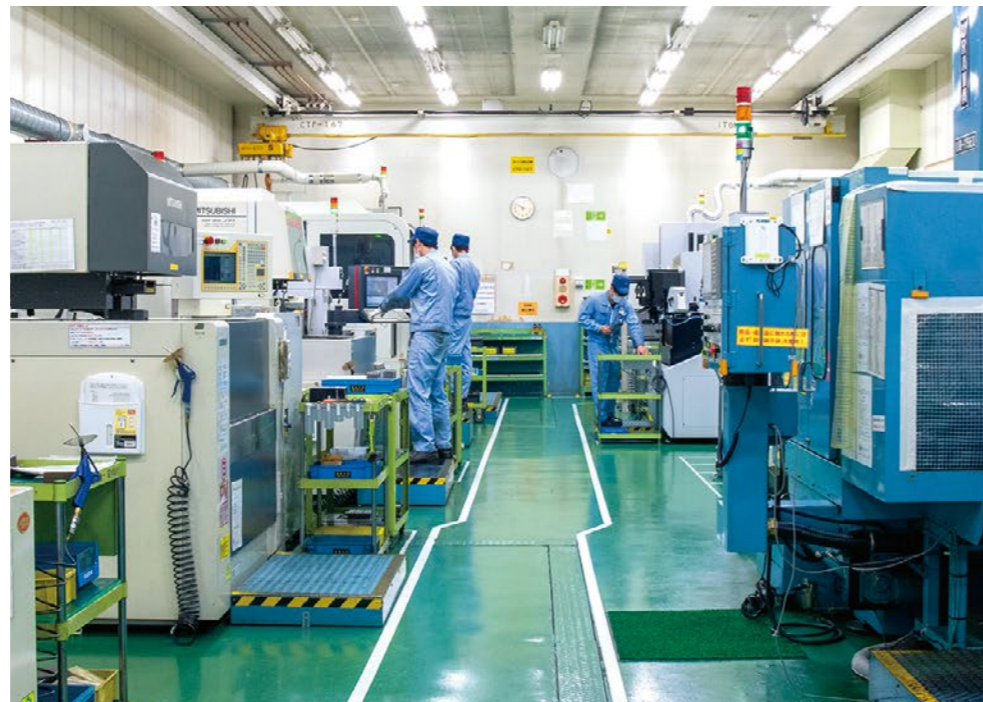
旧型機、他社製機械からも稼働データを収集。ランプの色を光センサーで捉えてデータ化するケースも。
