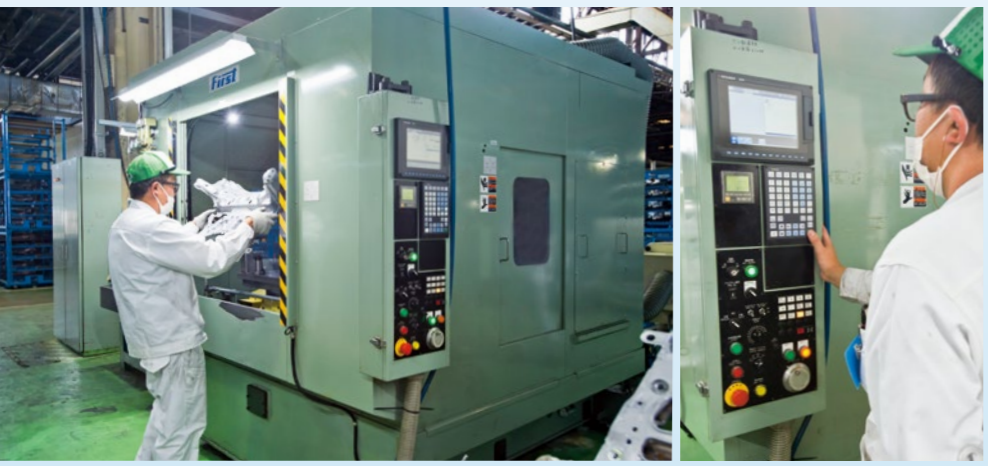
アルミ中空サブフレームの機械加工に活用している複合加工機。三菱電機のCNC「M70」を搭載している。
