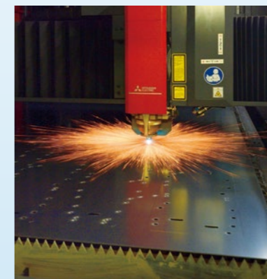
GX-F80とASTES4 SORTによるレーザ加工の全工程自動化を実現。
