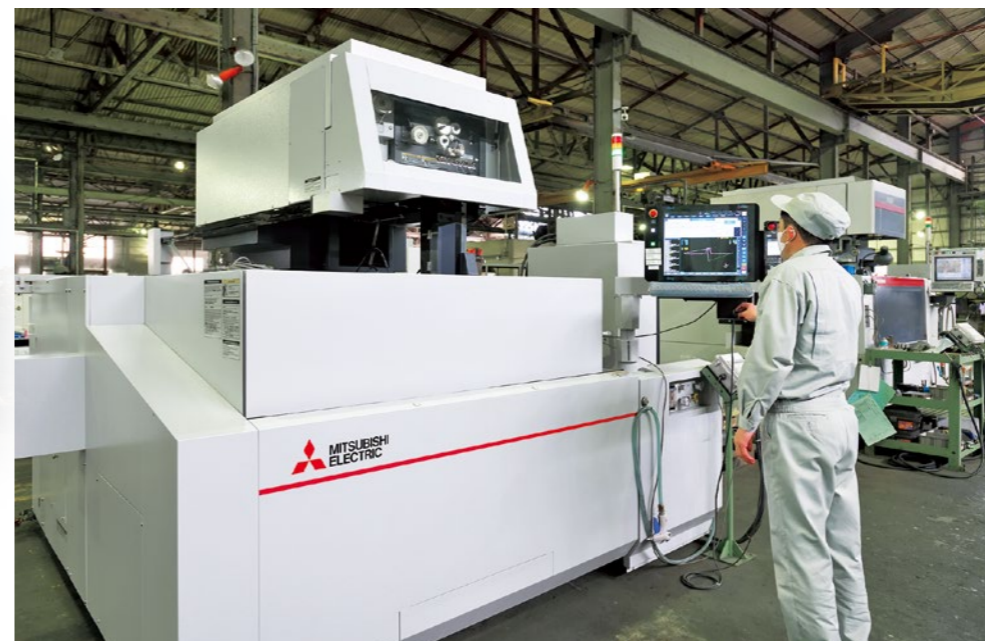
2020年導入のMV4800Sは“桂機械仕様”と呼ばれるほどに高速化の数々の工夫が盛り込まれた。
