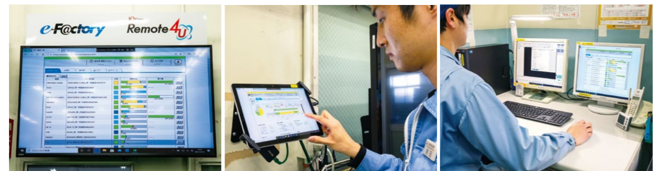
大型ディスプレイに全加工機の稼働データをグラフ表示し、別室の加工機の状態もひと目で確認。データは手元のタブレット端末やPCなど、さまざまなところからチェックできる。
